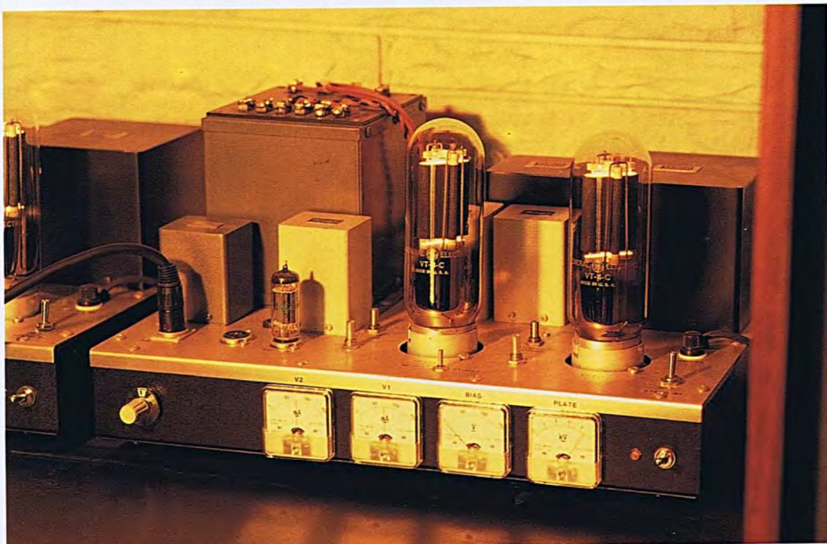
▲超大型真空管WE-211Dプッシュ・プル30Wモノラル・パワーアンプをJBL4350のウーファーに使用中。 文中に登場する新(あたらし)忠篤氏の力作で、中高域には同じく新氏製作のWE-329Aダブル・プッシュ・プルアンプを受用している。 「4350が嬉しそうに鳴り始めたよ。」と語るご自身が一番嬉しそう!?
